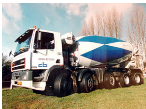
Фиг. 2.4. Автобетоносмесител на многоосно автомобилно шаси
